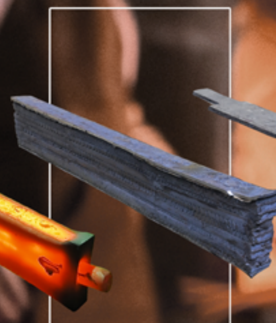
Заготовка, прошедшая стадии "проваривания" всех слоев стали.
