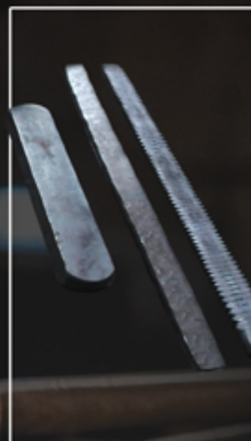
Пятидесятислойные заготовки, часть из которых была предварительно торсирована, а часть осталась с прямолинейным узором.
