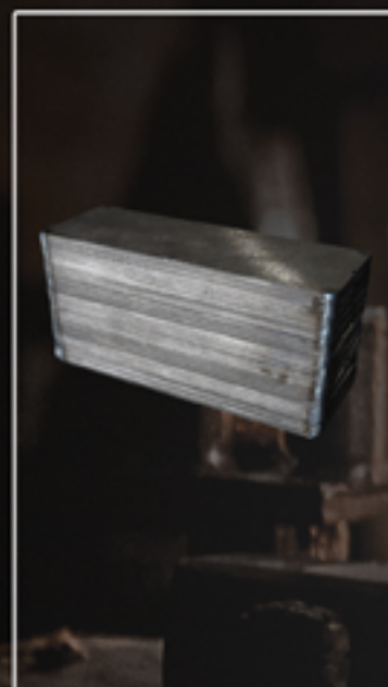
50 слоев высокоуглеродистой и среднеуглеродистой низколегированной стали.
