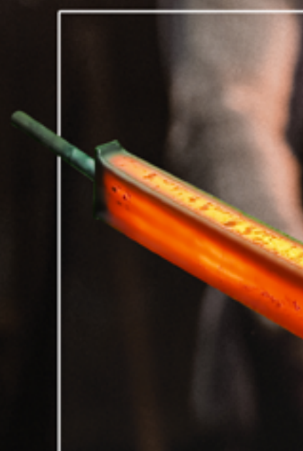
Пакет заготовок находится в начальной стадии традиционной кузнечной сварки.
