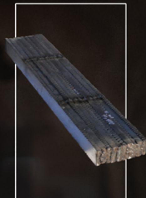
Заготовки, прошедшие химическую очистку и сваренные под прессом.
